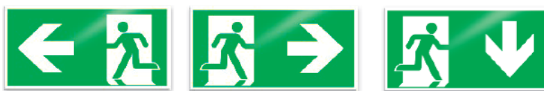
รูปที่ 11 แสดงแบบสัญลักษณ์มีขนาด 150 x 300 mm
