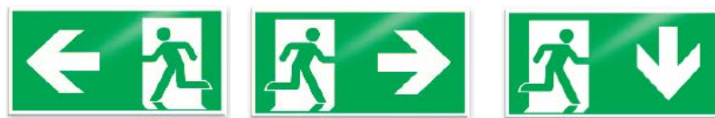
รูปที่ 1 รูปแบบสัญลักษณ์มีขนาด 150 x 300 mm
